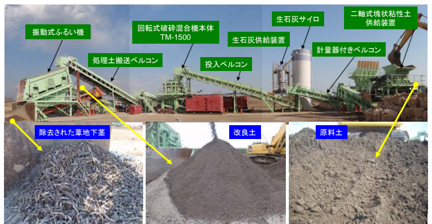
写真-1 回転式プラントおよび原料土・改良土・除去された葦地下茎
